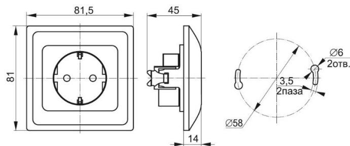
Провода подключаются не более двух под винтовой зажим. Это позволяет соединять между собой установленные рядом розетки или выключатели. Монтаж изделия в коробку возможен как с помощью саморезов, так и с помощью распорных лапок. В последнем случае нужно следить, чтобы провода не попадали под них.
