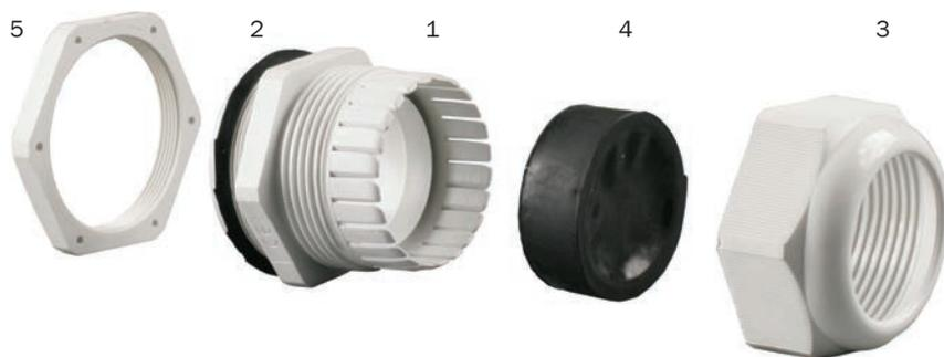
Сальник состоит из корпуса (1), уплотнителя (2), гайки уплотнения (3), прокладки (4) и фиксирующей гайки (5). Уплотнитель и прокладка выполнены из неопрена.
