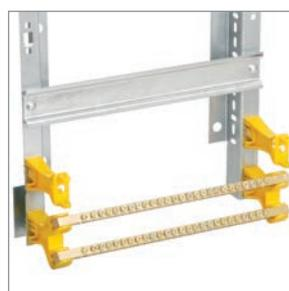
Шины N и PE защелкиваются в держатели стойки, которые устанавливаются в гнезда монтажных профилей при помощи зацепов. Такое расположение шин делает более удобным подвод кабелей.
