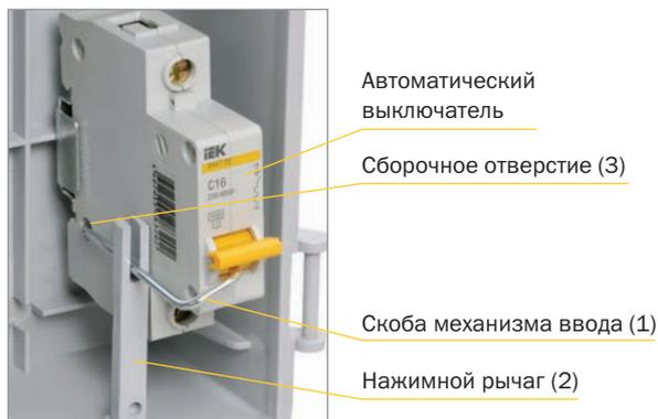
Для оперирования рукояткой автоматического выключателя корпус снабжен нажимным механизмом взвода, позволяющим включать автоматический выключатель, не открывая корпус.
