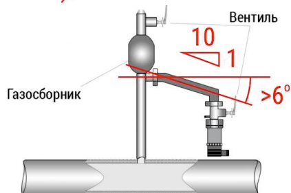
Рисунок 8 – Способы монтажа преобразователя для измерения давления жидкости
