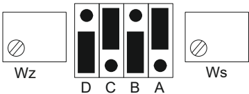
Рисунок 19 – Элементы для настройки диапазона LCD дисплея
