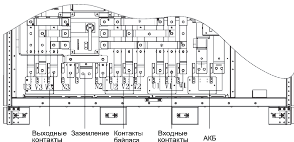
Рисунок 22 – Шина с клеммами для моделей 250–300 кВА
