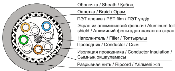
Рисунок 5 – Конструкция кабеля категории 8.1 типа S/FTP / Figure 5 – Cable design of 8.1 category, S/FTR type / 5 сурет – S/FTP типті 8.1 санатты кабельдің конструкциясы
