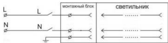
Схема подключения светильника
