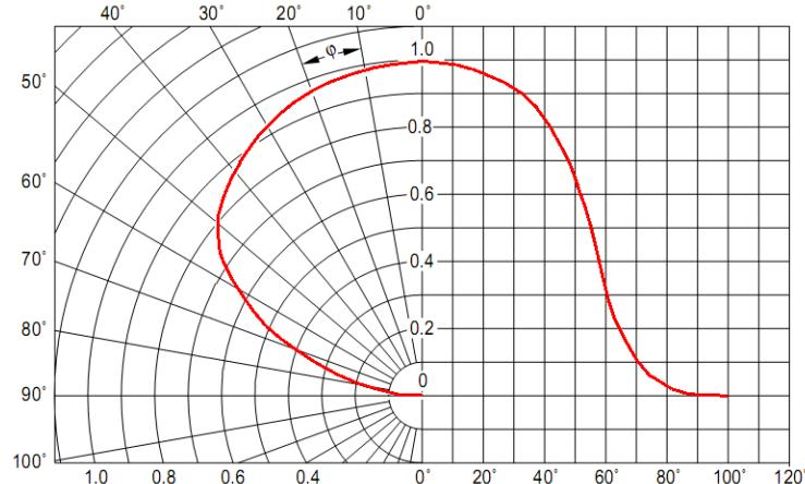
Рисунок 4 Тип КСС в исполнении «Д»
