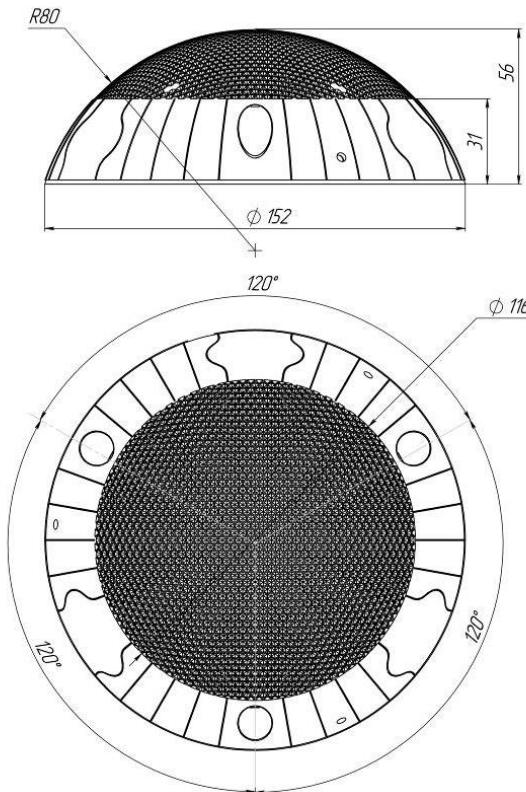
Рисунок 1 Светильник «Sveteco NEW 8»
