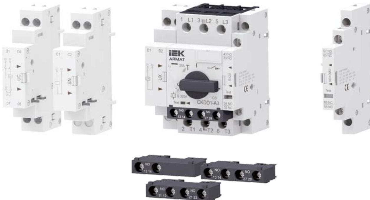
Автоматические выключатели защиты двигателя типа GV2P серии АМАТ предназначены для управления электроприводами с трехфазными асинхронными электродвигателями и для защиты от перегрузки, коротких замыканий и неполнофазных режимов работы.
