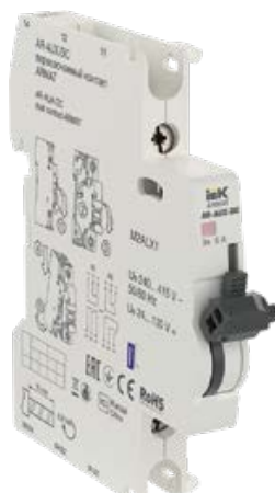
Переключаемый контакт ARMAT AUX-DC. В состав устройства входят два переключающих контакта: контакт состояния (КС) и контакт состояния/контакт аварийный (КС|КА). Контакт КС|КА работает в зависимости от положения переключателя функции либо как контакт состояния, либо как контакт аварийный.
