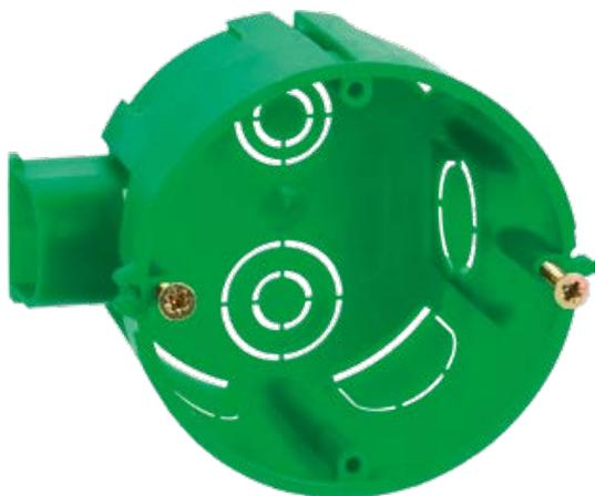
Установочные и монтажные коробки для твердых стен предназначены для скрытого монтажа в стены из кирпича или бетона. Уникальная конструкция соединительных и фиксирующих защелок позволяет жестко соединять в блок монтажные коробки в горизонтальном или вертикальном положении и выдерживать расстояние между центрами коробок 71 мм.
