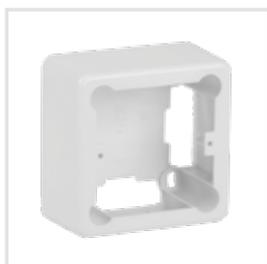
На внутренней стороне коробки имеет специальную разметку для установки кабель-каналов шириной 16–40 мм и высотой до 16 мм
