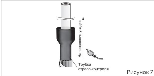
■ Надеть на каждую жилу трубку стресс-контроля до упора в отогнутые проволоки медного экрана. Усадить трубку с помощью горелки, начиная от проволоочного экрана и далее по направлению к концу жилы (рис. 7).
