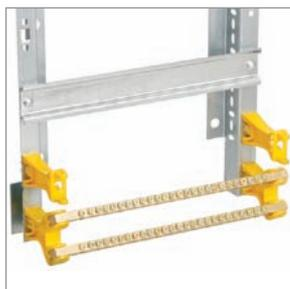
Шины N и PE защелкиваются в верхние держатели стойки, которые устанавливаются в гнезда монтажных профилей при помощи зацепов. Такое расположение шин делает более удобным подвод кабелей.
